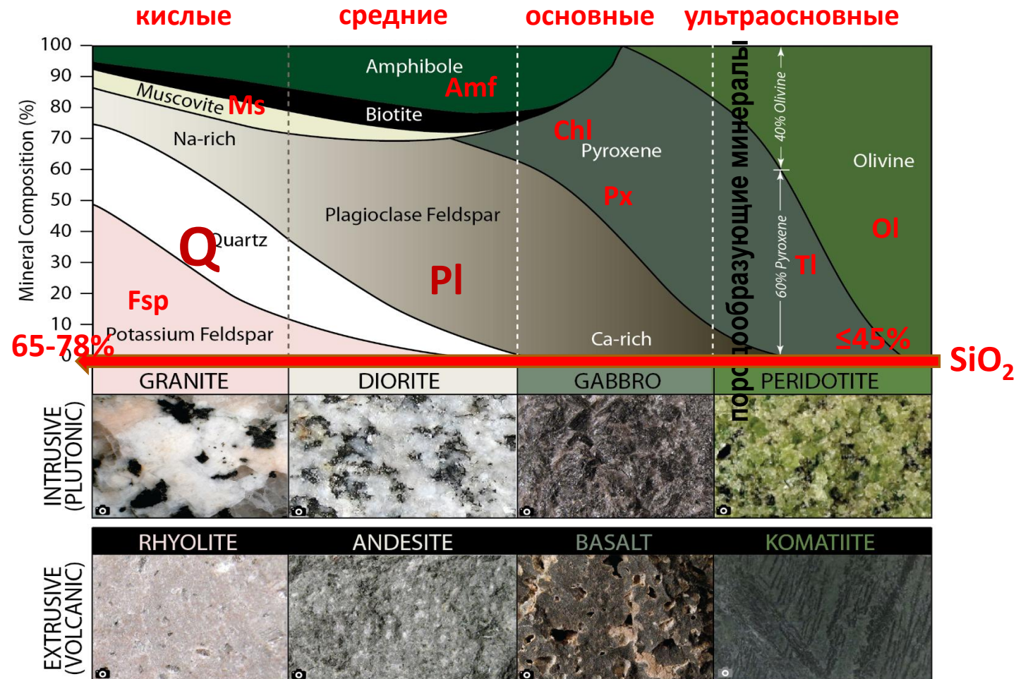
Принципиальная схема минерального состава основных типов магматических горных пород
